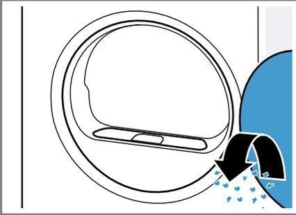
3. Das zweiteilige Flusensieb entfernen.
