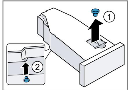
2. Den Filter im Kondenswasserbehälter reinigen.
