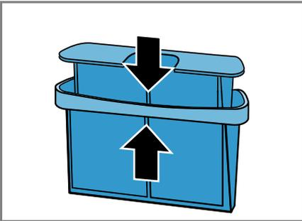
10. Das zweiteilige Flusensieb einsetzen.
