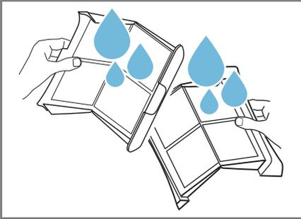
9. Die beiden Flusensiebe schließen und zusammensetzen.
