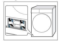
3. Die Wärmetauscherabdeckung am Griff herausziehen.
