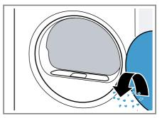
Das zweiteilige Flusensieb entfernen.
