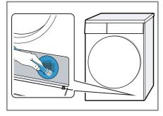
Stellen Sie sicher, das Gitter dabei nicht zu verformen oder zu beschädigen. 8. Die Öffnung mit einem weichen, feuchten Tuch reinigen.
