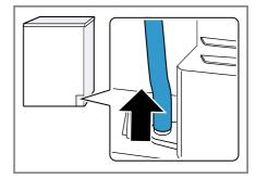
Der Kondenswasserschlauch ist werkseitig am Stutzen angeschlossen.
