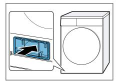
2. Die Hebel der Wärmetauscherabdeckung schließen.
