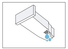
Stellen Sie sicher, den Kondenswasserbehälter vor dem Betrieb des Geräts einzuschieben.
