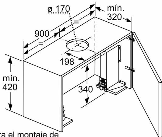
Para el montaje de la campana telescópica de 90 cm en un armario superior de 90 cm de anchura, es necesario un juego de montaje. Ambas escuadras de montaje se atornillan al mueble a derecha e izquierda. Montaje según plantilla. Dimensiones en mm
