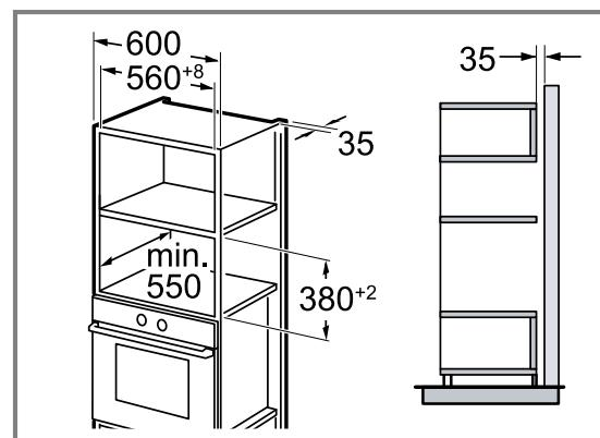
Encastrez l'appareil uniquement à une hauteur permettant de retirer sans problème les accessoires. Réglez les pieds.
