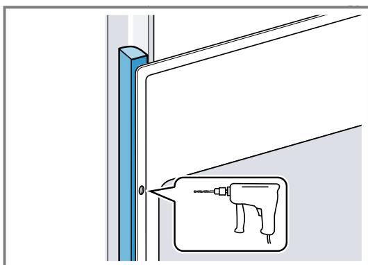
4. Het apparaat met adequate schroeven bevestigen.
