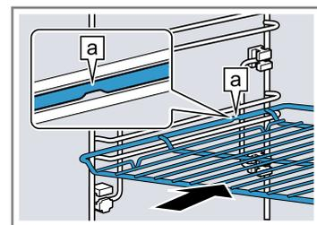
Blech z. B. Universalpfanne oder Backblech Das Blech mit der Abschrägung
