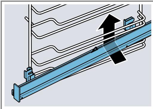
2. Die Schiene längs zu den Führungsstäben nach hinten führen und beide Halterungen jeweils auf den unteren Stab aufschieben. Dabei mit der hinteren Halterung **b** den senkrechten Stab umgreifen.
