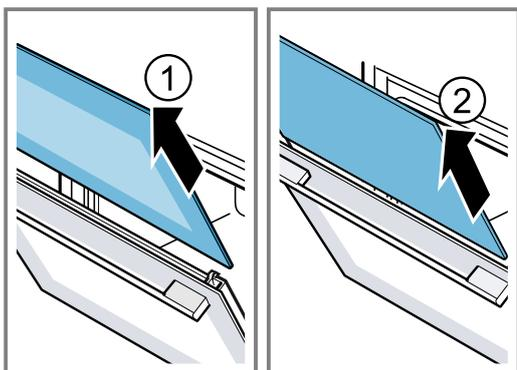
8. Die Gerätetür öffnen und Türdichtung abnehmen.
