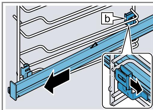
4. Die Auszugsschiene entfernen.
