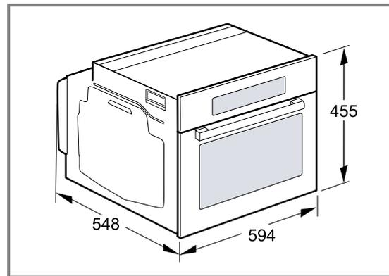
**30.3 Einbau unter einer Arbeitsplatte**
