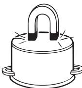
Führen Sie einen Magneten (z.B. einen Haftmagneten einer Magnettafel) an den Boden Ihres Kochgefäßes heran. Wird er kräftig angezogen, so können Sie das Kochgefäß auf der Induktionskochfläche benutzen.
