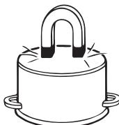
Si assicuri, che il recipiente rechi un avviso, che attesti l'idoneità alla cottura con un flusso induttivo o esegua il seguente test magnetico:
